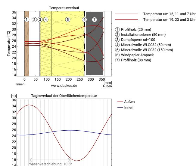
**Obere Abbildung:** Temperaturverlauf innerhalb des Bauteils zu verschiedenen Zeitpunkten. Jeweils von oben nach unten, braune Linien: um 15, 11 und 7 Uhr und rote Linien um 19, 23 und 3 Uhr morgens.
