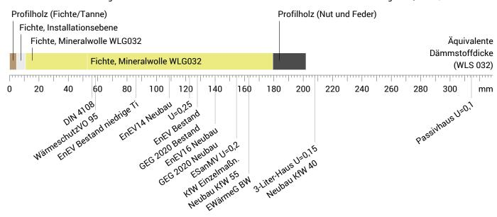
Raumluft: 20,0°C / 50% Dicke: 35.9 cm Außenluft: -5,0°C / 80% sd-Wert: 105,2 m Gewicht: 52 kg/m<sup>2</sup> Oberflächentemp.: 18,9°C / -4,8°C Wärmekapazität: 80 kJ/m²K
