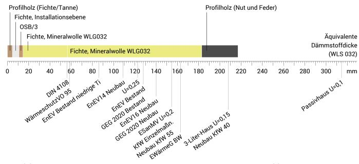
Raumluft:  $20,0^{\circ}\text{C} / 50\%$  Dicke: 42,0 cm Außenluft:  $-5,0^{\circ}\text{C} / 80\%$  sd-Wert: 109,7 m Gewicht:  $77 \text{ kg/m}^2$  Oberflächentemp.:  $19,0^{\circ}\text{C} / -4,9^{\circ}\text{C}$  Wärmekapazität:  $121 \text{ kJ/m}^2\text{K}$
